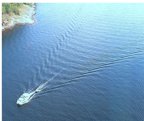
Rys. 2a. Fala dziobowa, towarzysząca łodzi poruszającej się z prędkością większą od prędkości fal na wodzie
