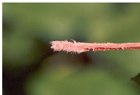
Rys. 5. Koniec rzemiennego bicia postrzępiony po kilkunastu strzałach
